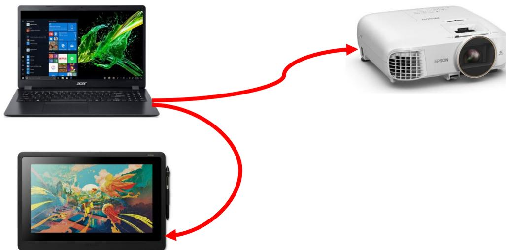
In tal caso la tavoletta grafica ed il proiettore sono visti dal PC come due schermi aggiuntivi. È necessario, utilizzando le funzionalità di estensione/clonazione del software della scheda video, Intel Graphics Control Panel, e non le funzionalità standard di Windows per la gestione degli schermi:
