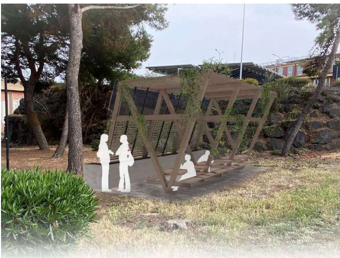
Struttura in legno predisposta per pannelli fotovoltaici e modalità di pavimentazione sottostante
