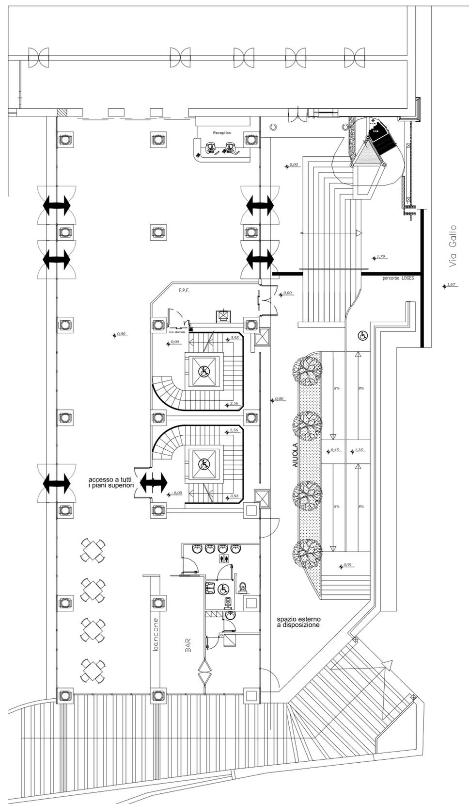
Stato di progetto - Planimetria, scala 1:100
