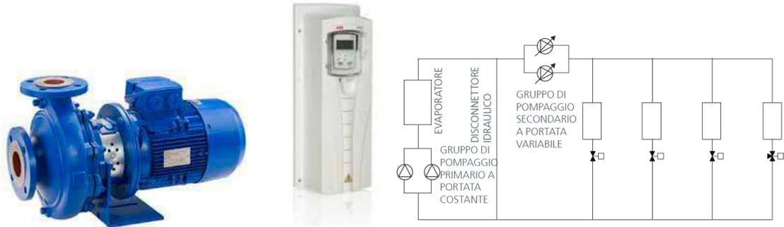
*impianto con pompa a portata costante a primario e variabile a secondario*
