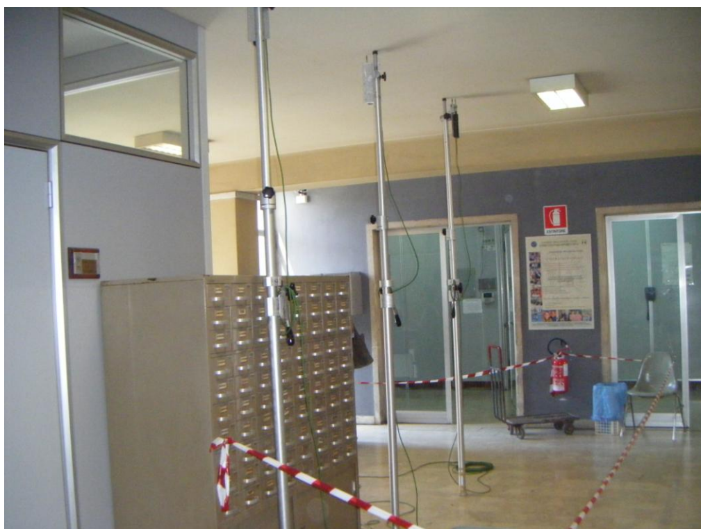
Foto 4.5. Sensori disposti per la misura degli spostamenti verticali del solaio
