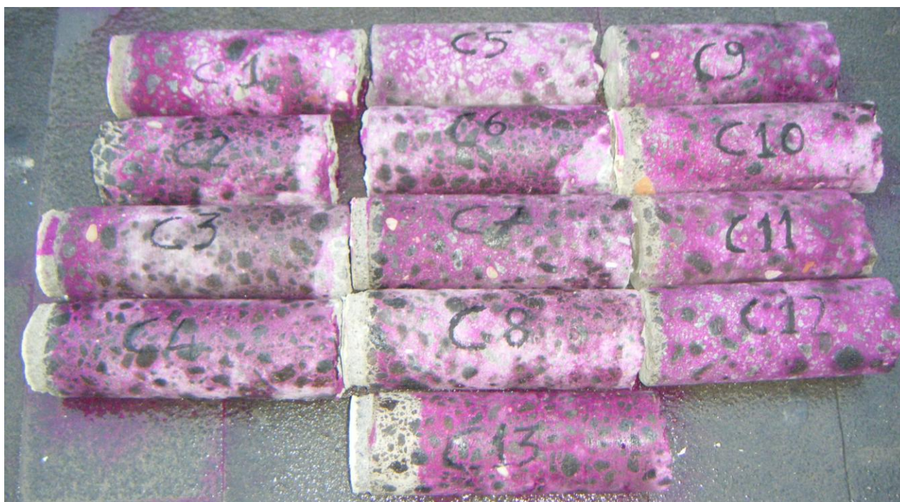
Foto 2.3. Carbonatazione sulle carote prelevate
