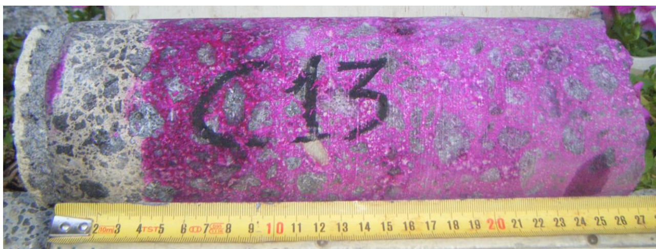
Foto 2.4. Misura della carbonatazione su un campione prelevato
