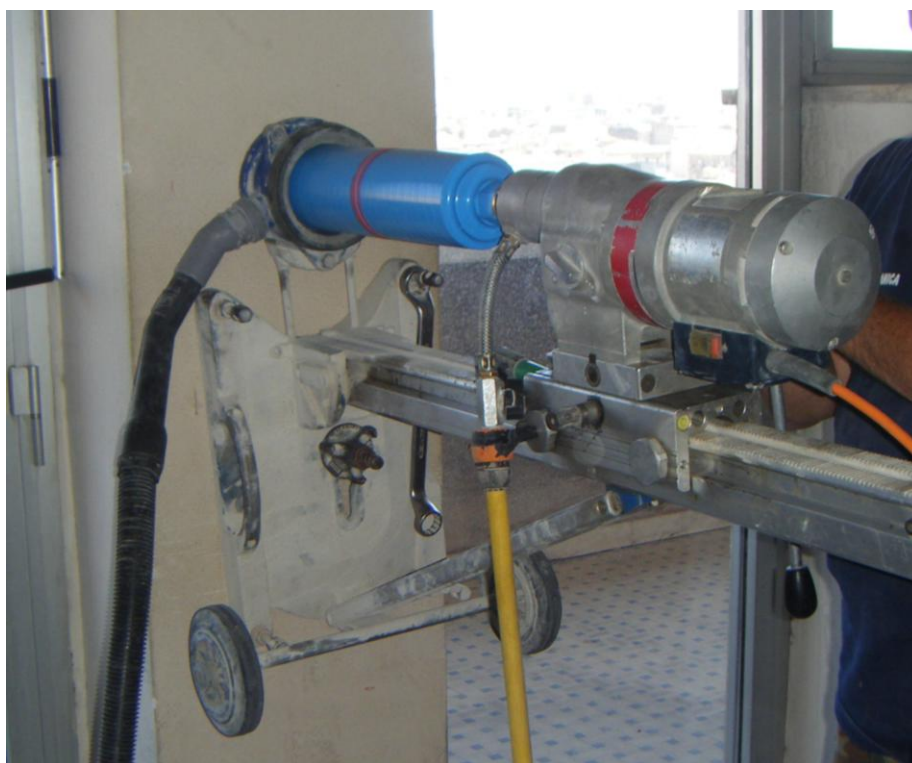
Foto 2.1. Esecuzione del carotaggio per il prelievo di un campione
