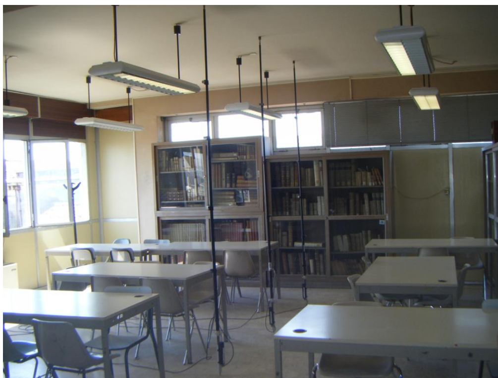
Foto 4.3. Sensori disposti per la misura degli spostamenti verticali del solaio
